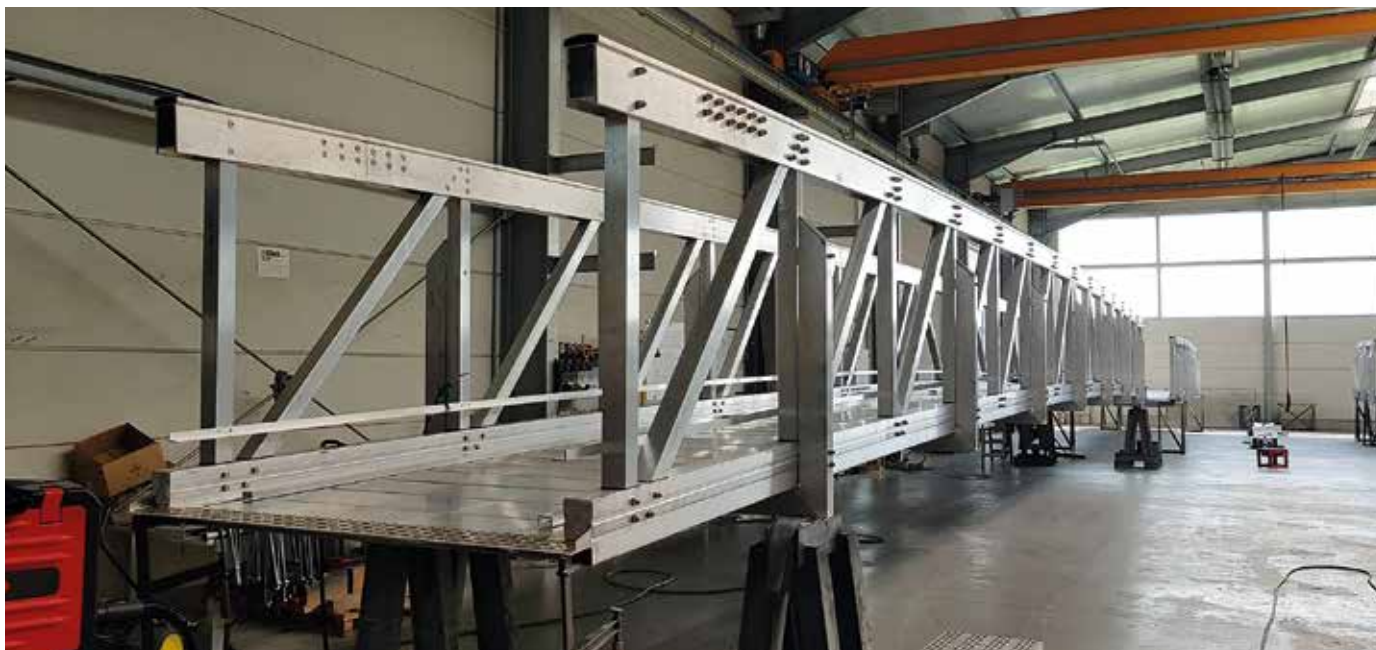
Die Fertigung der neuen Alu-Brücke bei der Cholerakapelle ist so gut wie abgeschlossen. © Glück, Ulbrich
